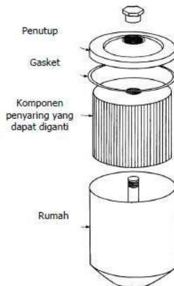
Gambar 16.10. Contoh filter yang dibongkar
